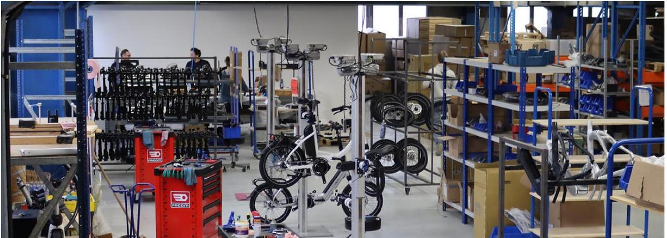
Au sein du collectif Grand Plateau (tiers lieu cycle de la métropole lyonnaise), Second Cycle possède sa propre chaîne de reconditionnement composé de 1700 m<sup>2</sup>, 10 pieds d'ateliers, 10 techniciens ainsi que tous les outils nécessaires (nettoyage, diagnostique, réparation, rayonnage de roues etc).
